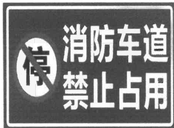
图 5 消防车通道禁止占用警示牌示例
