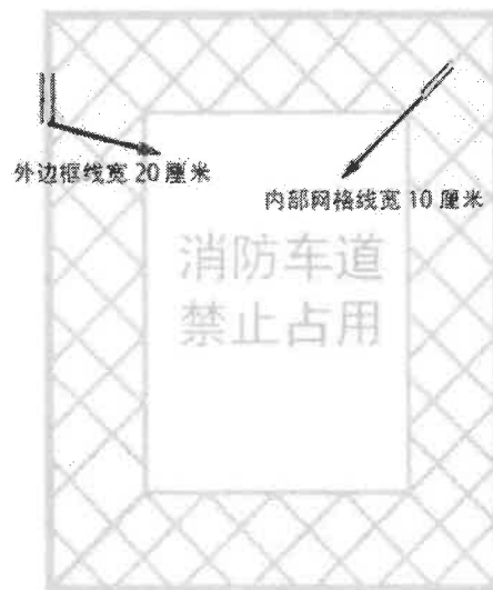
图 4 消防车通道出入口禁停标线及路面警示标志示例
